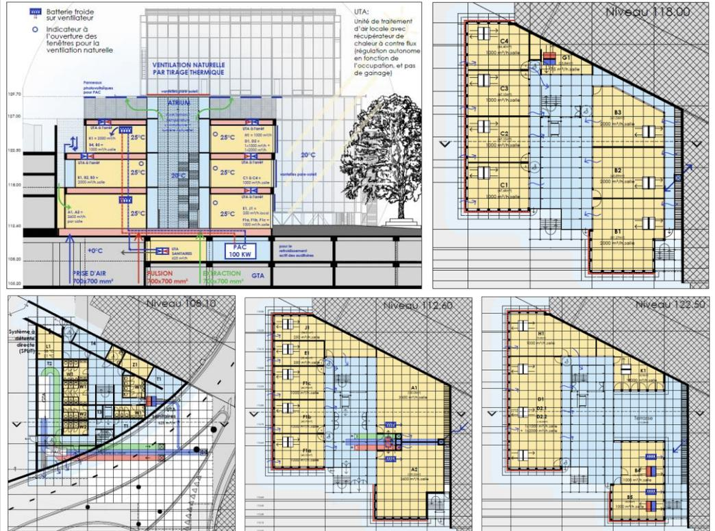
En dehors de la période de chauffage, extrêmement réduite, et dès que la température extérieure le permet, les locaux peuvent être ventilés naturellement. Un indicateur visuel présent dans chaque salle (système simple d'allumage d'une LED verte basé sur une combinaison de conditions intérieures et extérieures) indique les moments où la ventilation naturelle du local est possible.
